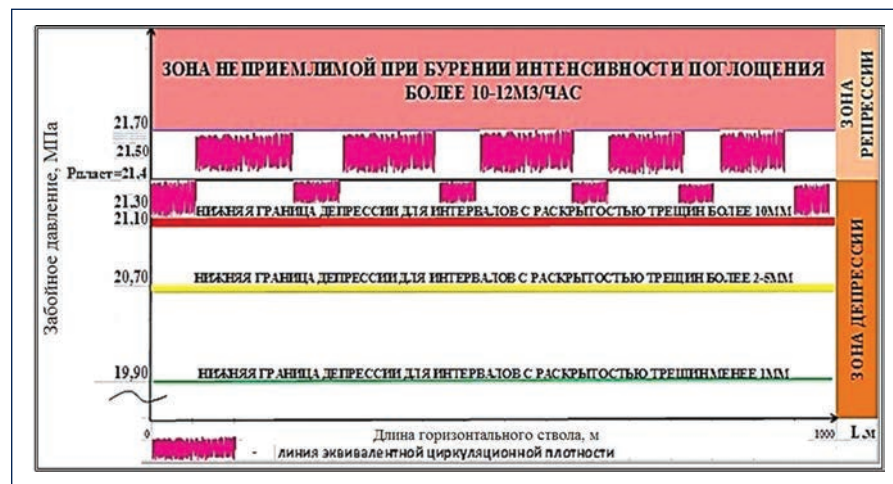
Рис. 1. Процесс первичного вскрытия с комбинированным регулируемым давлением (график совмещенных давлений)
