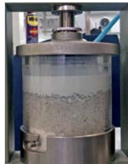
Рис. 3. Процесс фильтрации состава под давлением 6 МПа через кварцевый песок, имитирующий высокопроницаемый коллектор
