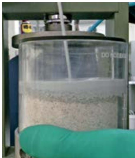
Рис. 2. Процесс фильтрации состава без воздействия избыточного давления через кварцевый песок, имитирующий высокопроницаемый коллектор
