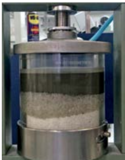
Рис. 1. Процесс фильтрации цемента марки G под давлением 6 МПа через кварцевый песок, имитирующий высокопроницаемый коллектор
