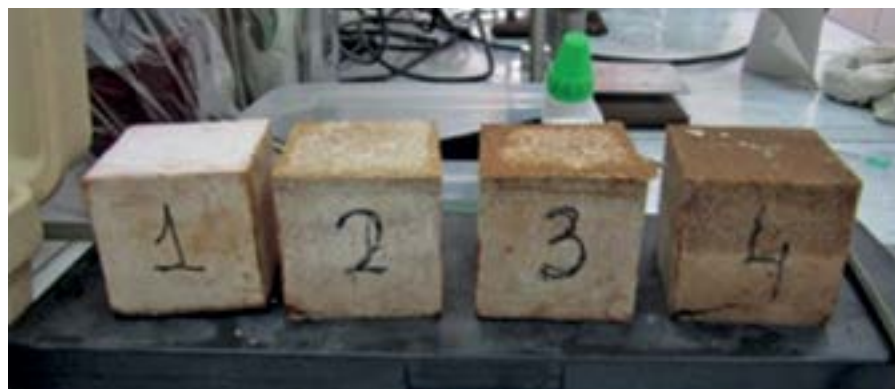
Рис. 4. Камень состава с различной степенью загрязнения раствором на углеводородной основе: 1 – без загрязнения; 2 – с 10%-ным загрязнением; 3 – с 30%-ным загрязнением; 4 – с 50%-ным загрязнением
