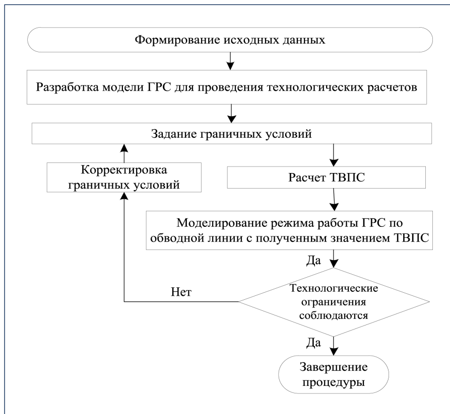
Рис. 1. Алгоритм определения технической возможной пропускной способности газораспределительных станций
