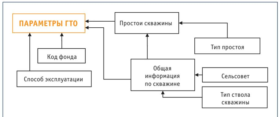
Рис. 2. Структура базы данных геолого-технической информации по скважинам
