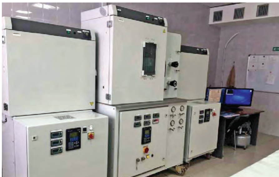
Рис. 1. Установка исследований нарушений продуктивных характеристик горных пород RPS-700 компании Vinci Technologies
